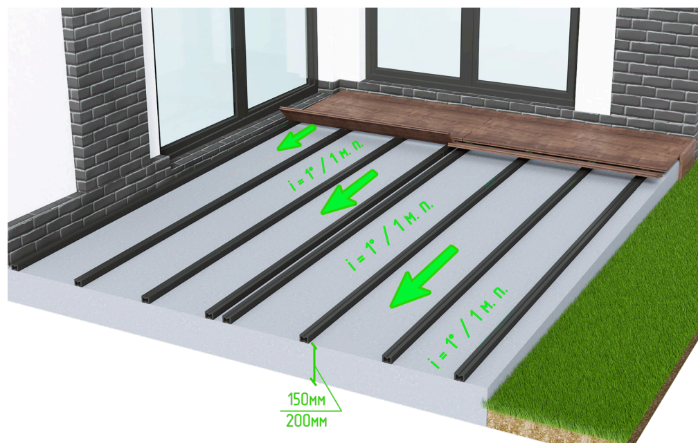
Установка стандартной лаги на бетонное основание с уклоном.
